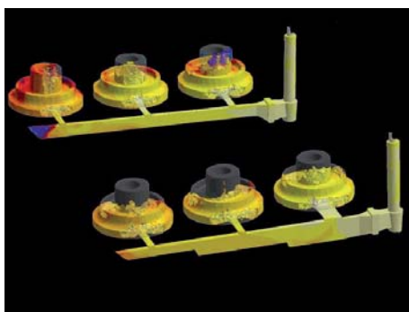
Obr. 3 Optimalizace tvaru vtokové soustavy (použito z www.magma-soft.com)
