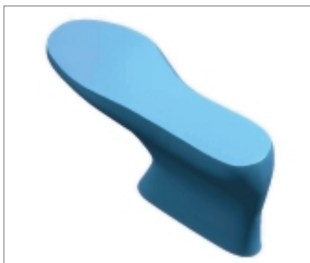
Obr. 8: Výsledek digitalizace a úpravy dat obuvnického kopyta v NX Unigraphics
