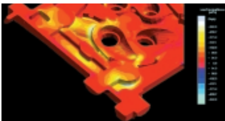
8 – Rozložení zbytkových pnutí u odlitku hlavy válců.
